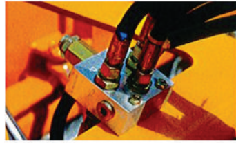
Bloc hydraulique avec clapet de sécurité
