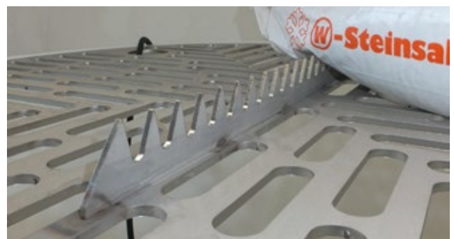
Bord tranchant pour couper les sacs
