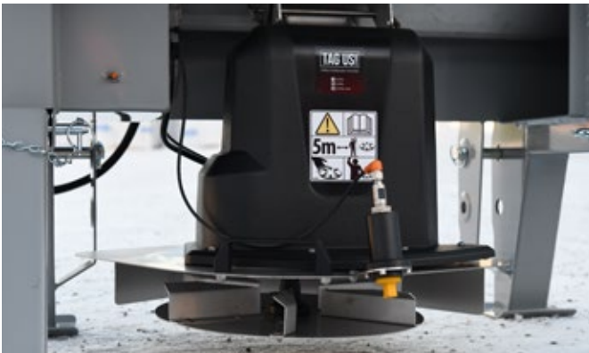
Capteur d'alarme de fin de matière sur disque d'épandage (en option)
