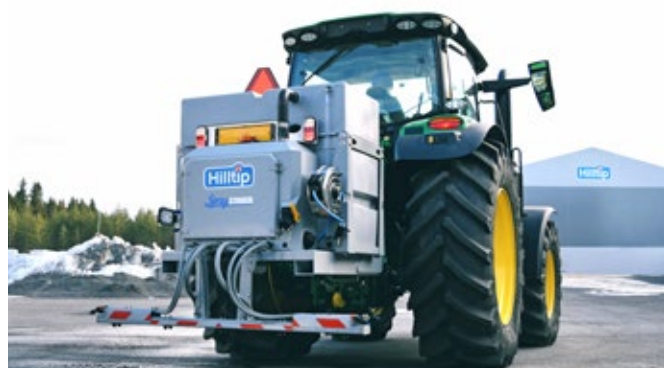
SprayStriker™ 800 avec cadre de montage sur attelage 3 points en option
