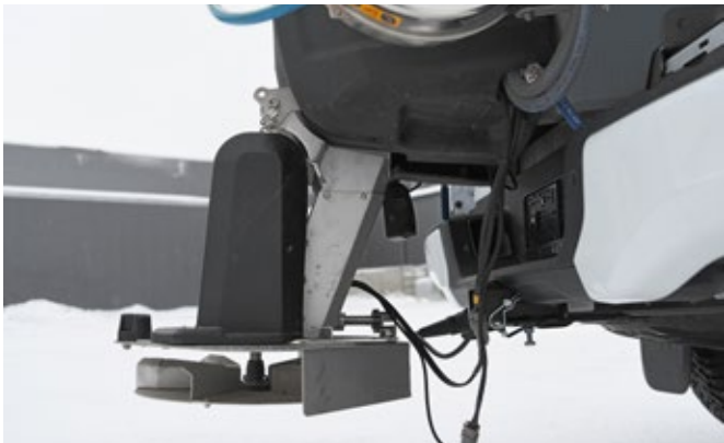
Goulotte rabattable en acier inoxydable. Conçu pour l'épandage de sel avec un niveau humide élevé.
