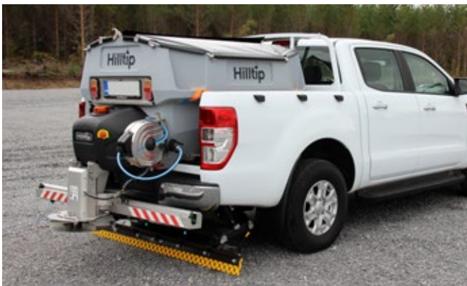
Enrouleur avec tuyau et rampe de pulvérisation (en option)
