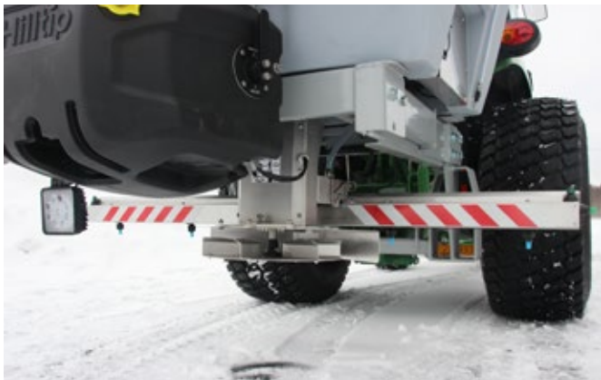
Rampe de pulvérisation en option, 600 TR
