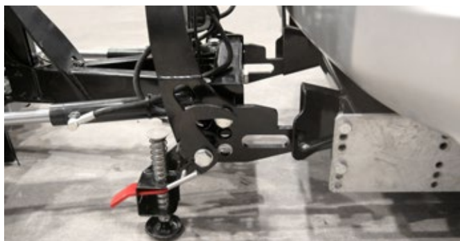
Attache Quick Hitch – système de montage rapide
