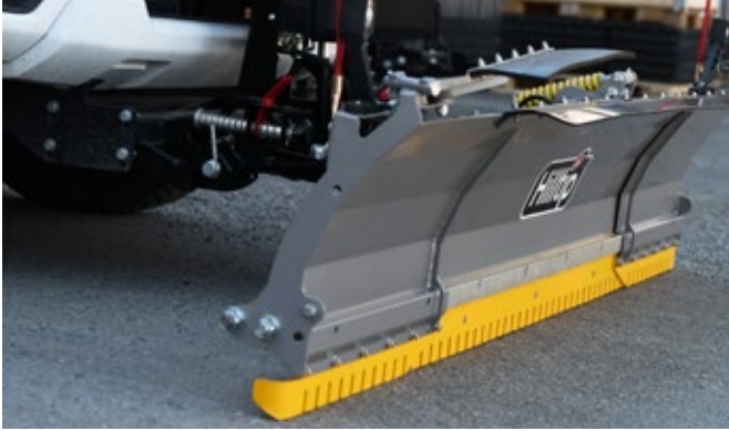
Les plaques de guidage latérales peuvent être repliées manuellement
