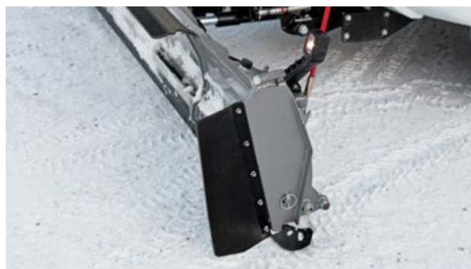
Plaque de guidage latérale et marqueur de bord à LED
