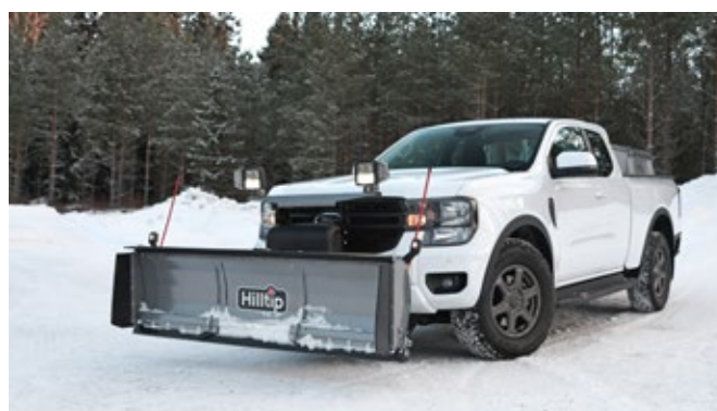
Lame SnowStriker™ 18-26 Flex en position compacte
