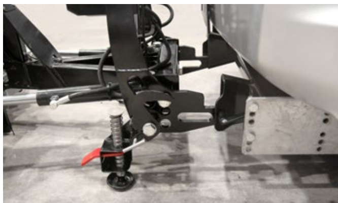
Attache Quick Hitch – système de montage rapide
