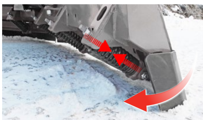
Racleur avec ressorts de déclenchement
