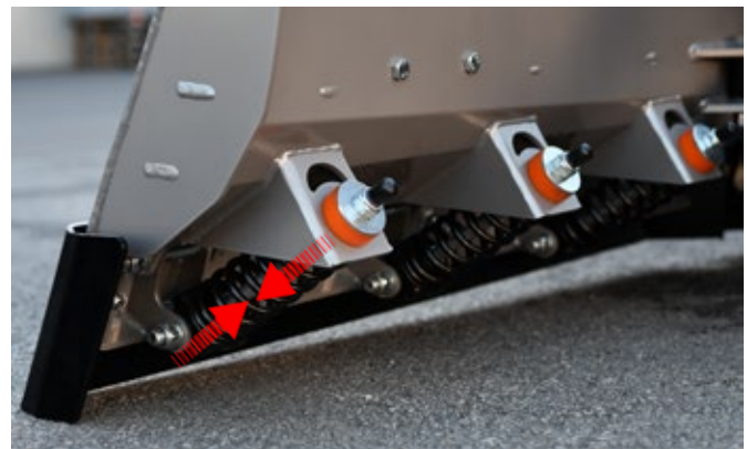
Racleur avec ressorts de déclenchement
