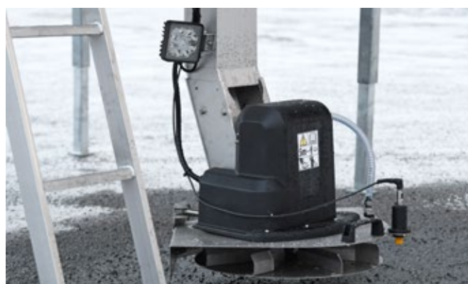
Feu de travail à LED et capteur d'alarme de fin de matière
